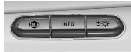
Il comando HUD è a sinistra del volante sul quadro strumenti per i veicoli con guida a sinistra e a destra del volante sul quadro strumenti per i veicoli con guida a destra.
