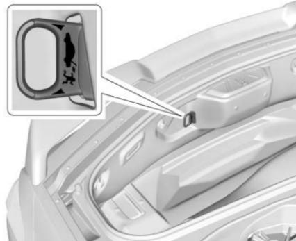
C'è una maniglia di sblocco di emergenza del portellone/bagagliaio fluorescente sulla parete posteriore interna del vano di carico. La maniglia si illumina a seguito
