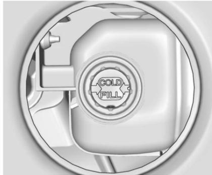
Quando il motore è freddo, il livello del liquido di raffreddamento deve trovarsi in corrispondenza dell'indicatore COLD FILL (riempimento a freddo) del vaso di espansione del liquido.
