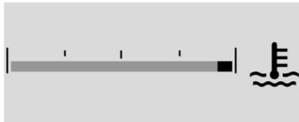
Questo indicatore indica la temperatura del liquido di raffreddamento del motore.
