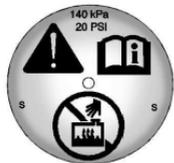
2. Quando l'impianto di raffreddamento, compreso il tappo a pressione del vaso di espansione del liquido di raffreddamento e il motore non sono più caldi, rimuovere il tappo a pressione.
