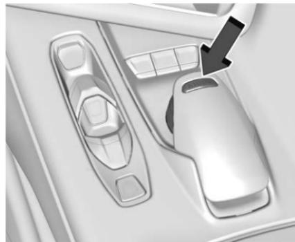
Per attivare My Mode, Weather, Tour, Sport e Track Mode, ruotare la manopola del Driver Mode Control (DMC) sulla consolle centrale per selezionare una modalità. Quando si seleziona una modalità, si accende una spia nel quadro strumenti che rimane accesa.
