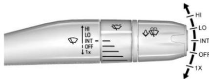
La leva del tergicristalli si trova sul lato destro del piantone dello sterzo.
