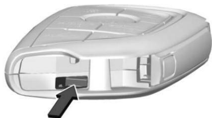
2. Usare la parte metallica della chiave nella fessura per rimuovere il coperchio della batteria manualmente.
