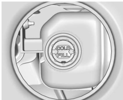
4. Riempire il vaso di espansione del liquido di raffreddamento con una miscela adeguata fino a quando il livello si stabilizza in corrispondenza dell'indicatore COLD FILL nel vaso di espansione.
