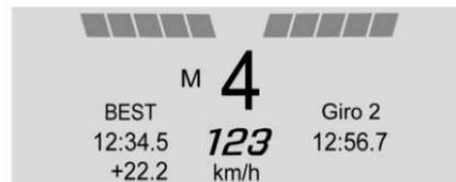
**Track** : Visualizza la velocità del veicolo, la posizione della marcia, le spie del cambio e i tempi di percorrenza del giro correnti/migliori. Ciò include le differenze in eccesso o in difetto del giro corrente rispetto al giro migliore.
