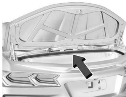
Usare la maniglia a coppa per chiudere il portellone/bagagliaio con lieve forza finché non si attiva la funzione di chiusura elettrica. Il portellone/bagagliaio si chiuderà per la corsa rimanente bloccandosi automaticamente.
