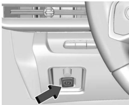
Il freno di stazionamento elettrico (EPB) può sempre essere inserito anche a veicolo spento. In caso di energia elettrica insufficiente, il sistema EPB non può essere applicato o rilasciato. Per impedire alla batteria di scaricarsi, evitare inutili cicli ripetuti dell'EPB.
