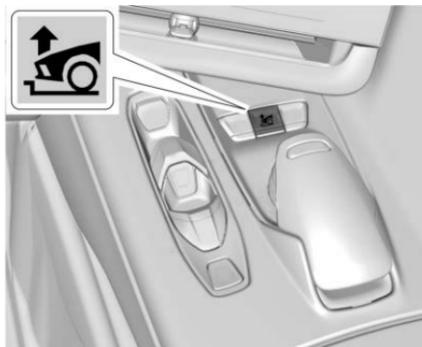
Per usare il sistema di sollevamento superiore, premere il pulsante sulla consolle centrale per sollevare o abbassare il veicolo. Questa funzione può essere azionata a velocità fino a 38 km/h (24 miglia/h) con motore in funzione. Il sistema funziona in base allo stato e alla modalità di funzionamento del veicolo:
