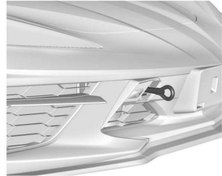
Montare l'occhiello di traino nell'incavo e ruotarlo fino a quando non sia completamente serrato.
