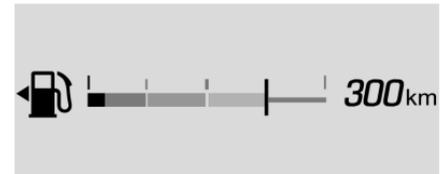
Con l'accensione inserita, l'indicatore del livello di carburante indica la quantità di carburante residuo nel serbatoio.
