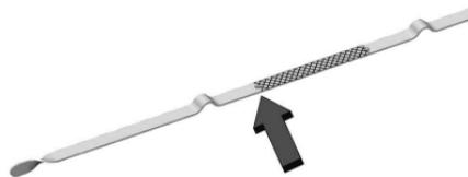
Se l'olio è al di sotto dell'area ombreggiata sulla punta dell'asta di livello, aggiungere 1 litro (1 qt) di olio raccomandato dall'apertura del tappo di riempimento olio nel tubo di riempimento del serbatoio dell'olio, quindi ricontrollare il livello. Per il tipo di olio da usare, vedere "Scelta dell'olio motore appropriato" più avanti in questa sezione. Per la capacità del basamento dell'olio motore, vedere *Capacità e specifiche* ⇨ 353.
