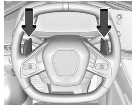
Con il cambio in D (Drive), premere l'interruttore M (Modalità manuale) sulla consolle centrale per entrare in modalità manuale. Usare le levette sul volante per cambiare a marcia superiore o scalare. La levetta di destra + (più) serve per aumentare la marcia, mentre quella di sinistra - (meno) per scalare.
