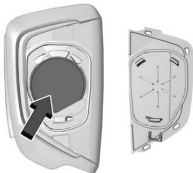
3. Rimuovere la guarnizione tirando la linguetta per accedere alla batteria.
