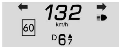
**Tour** : Visualizza la velocità del veicolo, la posizione della marcia, l'indicatore del cambio e il segnale di velocità.
