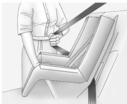
6. Estrarre completamente la fascia toracica dal riavvolgitore per bloccare. Quando viene fissato il blocco del riavvolgitore, la cintura può essere tesa ma non estratta dal riavvolgitore.
