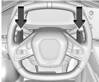
Con il cambio in D (Drive), premere l'interruttore M (Modalità manuale) sulla consolle centrale per entrare in modalità manuale. Usare le levette sul volante per cambiare a marcia superiore o scalare. La levetta di destra + (più) serve per aumentare la marcia, mentre quella di sinistra - (meno) per scalare.
