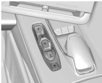
Questo veicolo è dotato di cambio dual-clutch che contiene un differenziale posteriore integrato. Il cambio dual-clutch trasmette una sensazione di estremo
