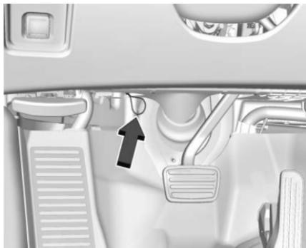
1. Localizzare l'anello del cavo di sblocco manuale a sinistra del pedale del freno.
