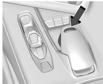
Per attivare My Mode, Weather, Tour, Sport e Track Mode, ruotare la manopola del Driver Mode Control (DMC) sulla consolle centrale per selezionare una modalità.
