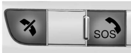
Il sistema eCall può anche essere attivato manualmente. Premere **SOS** sulla consolle superiore per contattare il centro emergenza 112 più vicino. Premere **☒** entro due secondi per annullare la eCall attivata manualmente.
