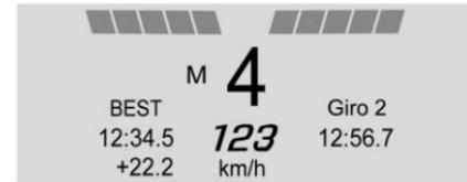
**Track** : Visualizza la velocità del veicolo, la posizione della marcia, le spie del cambio e i tempi di percorrenza del giro correnti/migliori. Ciò include le differenze in eccesso o in difetto del giro corrente rispetto al giro migliore.
