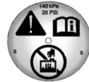
2. Quando l'impianto di raffreddamento, compreso il tappo a pressione del vaso di espansione del liquido di raffreddamento e il motore non sono più caldi, rimuovere il tappo a pressione.
