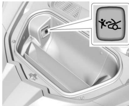
Il vano del sottocofano è dotato di un pulsante di sblocco del cofano di emergenza che brilla al buio. Il pulsante si illumina a seguito dell'esposizione alla luce. Premere il pulsante per aprire il cofano dall'interno del vano sottocofano.
