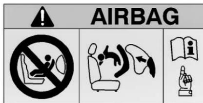
Non installare sulla vettura sistemi di sicurezza per bambini rivolti in senso contrario al senso di marcia, anche se l'airbag è disattivato.
