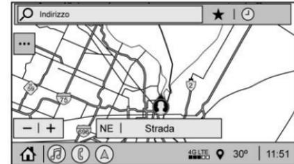
Dopo aver aperto l'applicazione Nav per la prima volta, l'applicazione inizia sempre con la visualizzazione della mappa intera con la posizione corrente del veicolo. Quando il veicolo si arresta, appare la barra di ricerca lungo il bordo superiore della mappa di navigazione. Si può chiudere manualmente la barra di ricerca toccando ✕. Quando il veicolo è in movimento, l'icona 📍 sostituisce la barra di ricerca per ampliare al massimo la visualizzazione della mappa.
