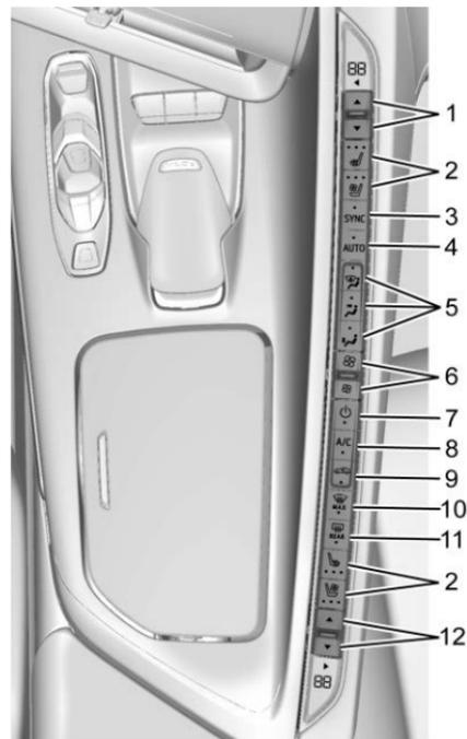
1. Controllo della temperatura del conducente
