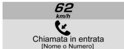
**Telefono** : Può visualizzare la ricezione di una chiamata in arrivo da un telefono Bluetooth collegato. Viene visualizzato provvisoriamente fino a quando la chiamata viene risposta o ignorata.
