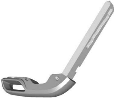
La chiave meccanica può essere utilizzata per aprire il veicolo e il portellone/bagagliaio in caso di mancanza di alimentazione elettrica dello stesso. Vedere *Berlina a due volumi (Bagagliaio)* ⇨ 23.
