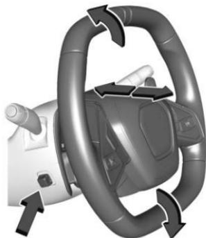
Premere il comando per spostare il volante a regolazione telescopica e dell'inclinazione in senso verticale o orizzontale.
