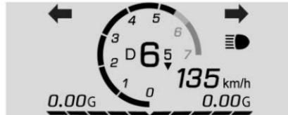
**Sport** : Visualizza la velocità del veicolo, il contagiri circolare, la posizione della marcia, l'indicatore del cambio e il misuratore della forza di gravità.
