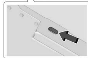
Utilizzare esclusivamente un martinetto da officina, con diametro del tampone di sollevamento di max 64 mm (2,5 in), abbastanza spesso da evitare il contatto tra martinetto e scocca del veicolo.
