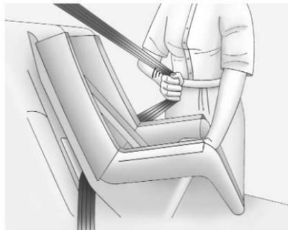
6. Estrarre completamente la fascia toracica dal riavvolgitore per bloccare. Quando viene fissato il blocco del riavvolgitore, la cintura può essere tesa ma non estratta dal riavvolgitore.
