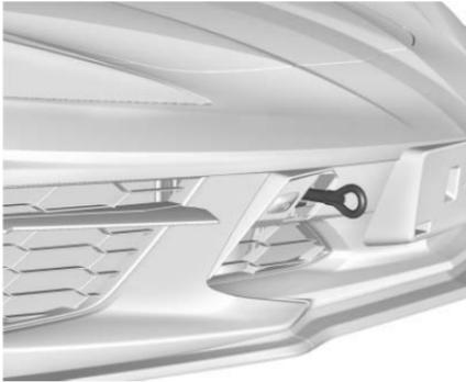
Montare l'occhiello di traino nell'incavo e ruotarlo fino a quando non sia completamente serrato.
