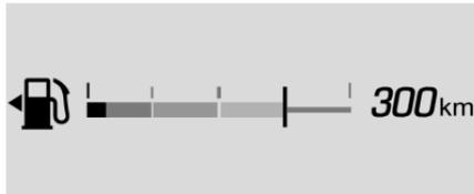
Con l'accensione inserita, l'indicatore del livello di carburante indica la quantità di carburante residuo nel serbatoio.
