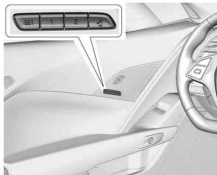
Se dotato di memoria, i pulsanti 1, 2, SET e
