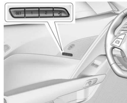
Se in dotazione, i pulsanti 1, 2, SET e
