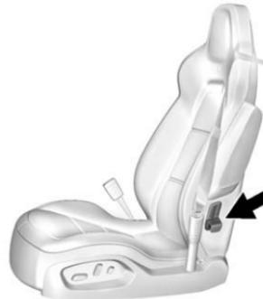
Se presente, sollevare il dispositivo di bloccaggio per ripiegare in avanti uno schienale.
