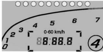
**Timing :** Visualizza il contagiri lineare, la posizione della marcia, le luci cambio e il timer prestazioni o il cronometro. Il contenuto visualizzato del timer prestazioni o cronometro varia in funzione delle caratteristiche attualmente in uso nel quadro strumenti. Vedere *Quadro strumenti* ⇨ 110.
