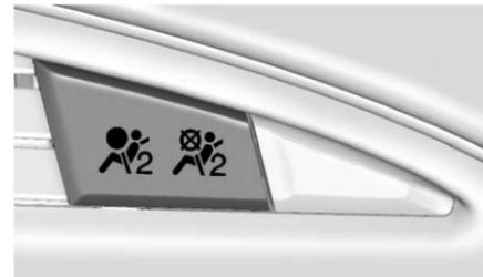
Il simbolo per l'attivazione e la disattivazione sarà visibile durante il controllo del sistema. Quando il controllo del sistema è completato, sarà visibile il simbolo di attivazione
