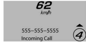
**Telefono :** Può visualizzare la ricezione di una chiamata in arrivo da un telefono Bluetooth collegato. Viene visualizzato provvisoriamente fino a quando la chiamata viene risposta o ignorata.
