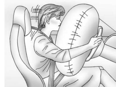
L'airbag frontale del conducente si trova al centro del volante.
