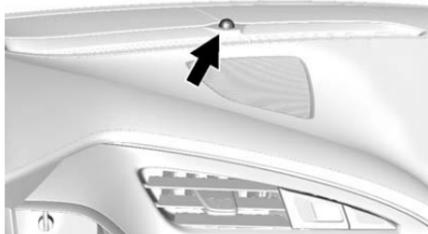
Un sensore di luce è ubicato sulla parte superiore del quadro strumenti. Non coprire il sensore. Altrimenti i fari si accenderanno quando non necessario.
