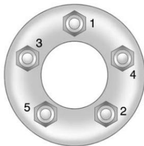
Serrare i dadi ruote saldamente in sequenza incrociata. Vedere *Capacità e specifiche* ⇨ 335.
