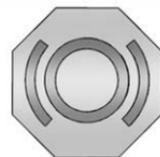
Il serbatoio del cilindro maestro freni è riempito di liquido dei freni DOT 3 come indicato sul tappo del serbatoio. Vedere *Panoramica del vano motore* ⇨ 241 per la posizione del serbatoio.
