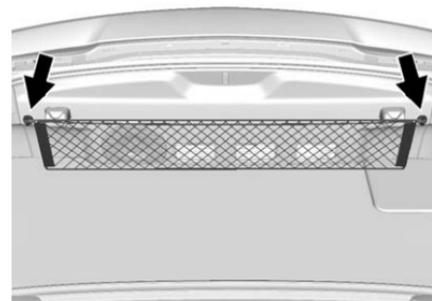
Il veicolo potrebbe essere dotato di rete di sicurezza da impiegare per i piccoli oggetti. Fissare la rete ai ganci nella parte posteriore dell'area di carico. La rete non deve essere usata per carichi pesanti.
