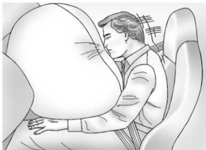
L'airbag anteriore del passeggero anteriore esterno si trova nel quadro strumenti del passeggero.
