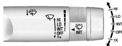
La leva del tergilavacrystalli si trova sul lato destro del piantone dello sterzo.
