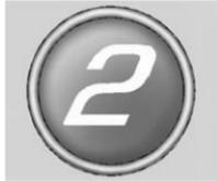
Quando si utilizza la funzione di cambio manuale sequenziale trovandosi in M (modalità manuale), la marcia corrente viene visualizzata nel quadro strumenti o nel display Head-Up (HUD), se presente. Vedere *Head-Up Display (HUD)* ⇨ 130.
