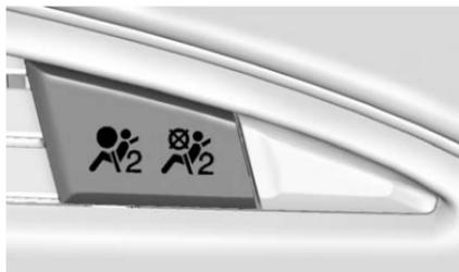
Il sistema di rilevamento del passeggero disattiva l'airbag frontale del passeggero esterno in alcune condizioni. Nessun altro airbag è interessato dal sistema di rilevamento del passeggero. Vedere *Impianto di rilevamento passeggero* ⇨ 77.
