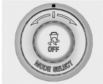
Per selezionare una modalità mentre è inserito il sistema PTM, ruotare la manopola Magnetic Ride Control/Performance Traction Management MODE SELECT sulla consolle centrale.
