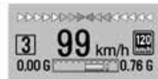
**Quarto formato:** Questa visualizzazione fornisce la lettura del tachimetro (in unità anglosassoni o metriche), le posizioni del cambio (solo per i veicoli con cambio automatico), la posizione delle spie sulle cambiate e gli indicatori dell'accelerazione laterale (G). Il display HUD non visualizza informazioni relative a radio, CD e telefono.
