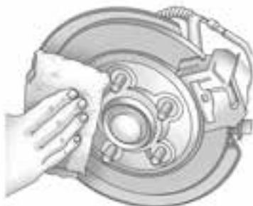
8. Rimuovere la ruggine e la sporcizia dai bulloni ruote, dalle superfici di montaggio e dal pneumatico di scorta.
