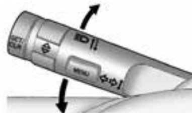
Sollevare o abbassare completamente la leva per segnalare una svolta.
