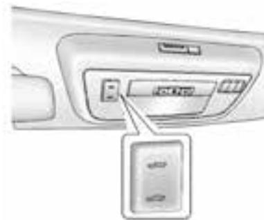
9. Premere la parte posteriore del pulsante della capote senza rilasciarla. I finestrini si abbasseranno automaticamente e il tetto convertibile si abbasserà nel retro del veicolo. Un segnale acustico avverte quando il tetto convertibile è stato aperto completamente. Se la radio è accesa il suono potrebbe essere silenziato per un breve tempo in modo da sentire il cicalino.
