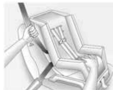
5. Per stringere la cintura, esercitare una pressione sul sistema di sicurezza, tirare la fascia toracica della cintura di sicurezza per rendere più aderente la fascia addominale e inserire la fascia toracica nel riavvolgitore. Quando si monta un sistema di sicurezza per bambini rivolto nel senso di marcia, potrebbe essere utile usare il ginocchio per premere sul sistema di sicurezza quando si stringe la cintura.
