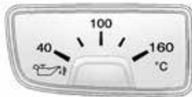
Per i veicoli dotati di questo indicatore, esso è posizionato di fronte alla leva del cambio e indica la temperatura dell'olio motore.
