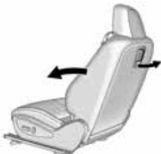
Per accedere ai sedili posteriori, tirare in alto la chiusura sul retro dello schienale del conducente o del passeggero anteriore. Abbattere lo schienale in avanti.
