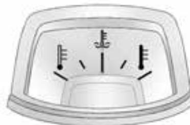
Questo indicatore indica la temperatura del liquido di raffreddamento del motore.
