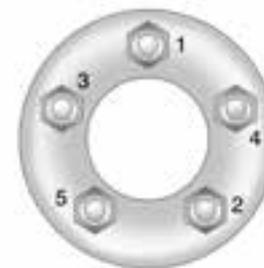
12. Serrare i dadi ruota saldamente in sequenza incrociata, come mostrato in figura.
