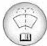
Aprire il tappo che riporta il simbolo lavavetri. Aggiungere liquido lavavetri fino a riempire il serbatoio. Per la posizione del serbatoio, vedere *Panoramica del vano motore a pagina 10-5*.
