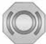
Il tappo del serbatoio del liquido dei freni/della frizione idraulica riporta questo simbolo. Il serbatoio comune del liquido del cilindro maestro freni e della frizione idraulica è riempito di liquido dei freni DOT 3 come indicato sul tappo del serbatoio. Per la posizione del serbatoio, vedere *Panoramica del vano motore a pagina 10-5*.
