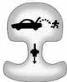
C'è una maniglia di sblocco d'emergenza del bagagliaio dentro al bagagliaio sul rivestimento, vicino al dispositivo di chiusura. Su alcuni veicoli, si può accedere alla maniglia di sblocco abbattendo lo schienale del sedile posteriore. Vedere *Sedili posteriori a pagina 3-6*.
