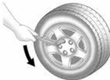
3. Utilizzare la chiave per ruota completamente estesa per allentare tutti i dadi ruota di mezzo giro in senso antiorario. Non rimuoverli in questo momento.
