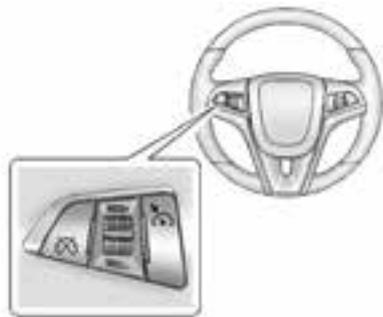
**⏻ (On/Off):** Attiva e disattiva il controllo automatico della velocità di crociera. Quando il controllo automatico della velocità di crociera è inserito, sul quadro strumenti si accende una spia bianca.
