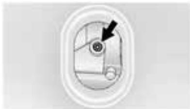
5. Localizzare la vite di scarico pressione sulla parte superiore della pompa idraulica.
