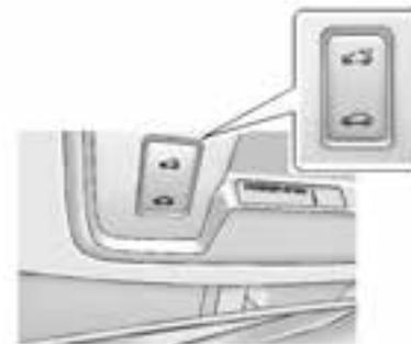
**Aprire/Chiudere:** Tenere premuta la parte posteriore o anteriore dell'interruttore per aprire o chiudere il tettuccio apribile.
