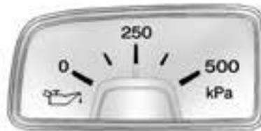
Per veicoli con manometro dell'olio, esso è posizionato di fronte alla leva del cambio e mostra la pressione dell'olio motore in kPa (chilopascal).
