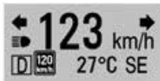
**Primo formato:** Questa visualizzazione fornisce la lettura del tachimetro (in unità anglosassoni o metriche), le indicazioni sulla direzione di svolta, l'indicazione sugli abbaglianti, le posizioni del cambio, l'allarme velocità e temperatura dell'aria esterna.
