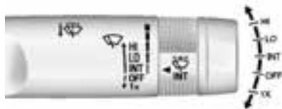
La leva del tergilavacristalli si trova sul lato destro del piantone dello sterzo. Con l'accensione del veicolo in posizione ACC/ACCESSORY o ON/RUN, spostare la leva del tergilavacristalli per selezionare la velocità del tergilavacristalli.
