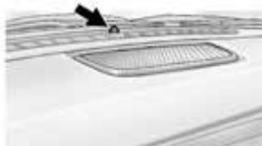
Il veicolo è dotato di un sensore di luce sulla parte superiore del quadro strumenti. Evitare di coprire questo sensore, altrimenti l'impianto si accende ogni volta che l'accensione è inserita.
