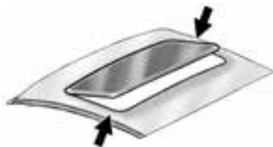
È possibile che sporcizia e altre impurità possano accumularsi nel guida o nella guarnizione del tettuccio apribile. Ciò potrebbe causare un problema con il funzionamento del tetto o il rumore. Potrebbe anche otturare il sistema di drenaggio dell'acqua. Aprire periodicamente il tettuccio e rimuovere tutti gli ostacoli o i residui sciolti. Pulire la tenuta del tettuccio e l'area di tenuta del tetto usando un panno pulito, sapone delicato e acqua. Non rimuovere il grasso dal tettuccio apribile.
