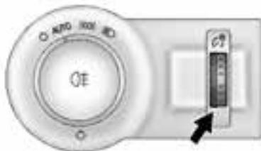
Questa funzione controlla la luminosità delle luci del quadro strumenti.
