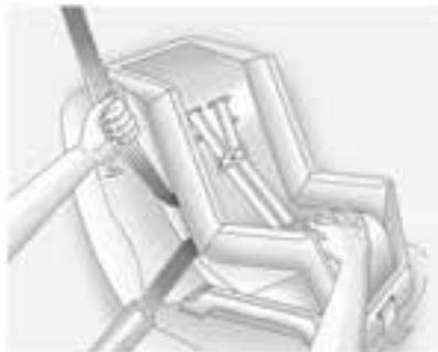
6. Per stringere la cintura, esercitare una pressione sul sistema di sicurezza, tirare la fascia toracica della cintura di sicurezza per rendere più aderente la fascia addominale e inserire la fascia toracica nel riavvolgitore. Quando si monta un sistema di sicurezza per bambini rivolto nel senso di marcia, potrebbe essere utile usare il ginocchio per premere sul sistema di sicurezza quando si stringe la cintura.
