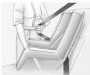
4. Estrarre completamente la fascia toracica dal riavvolgitore per bloccare. Quando viene fissato il blocco del riavvolgitore, la cintura può essere tesa ma non estratta dal riavvolgitore.
