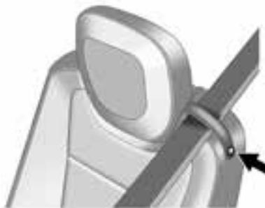
1. Se il sedile ha una guida per cintura di sicurezza e la cintura di sicurezza non passa attraverso la guida, posizionare la guida attorno al nastro della cintura. Assicurarsi che la cintura non sia ritorta.
