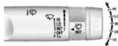
La leva del tergicristalli si trova sul lato destro del piantone dello sterzo. Con l'accensione del veicolo in posizione ACC/ACCESSORY o
