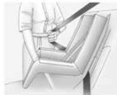
5. Estrarre completamente la fascia toracica dal riavvolgitore per bloccare. Quando viene fissato il blocco del riavvolgitore, la cintura può essere tesa ma non estratta dal riavvolgitore.
