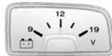
Per i veicoli con tale indicatore, esso è posizionato di fronte alla leva del cambio e mostra lo stato di carica della batteria in volt di CC.
