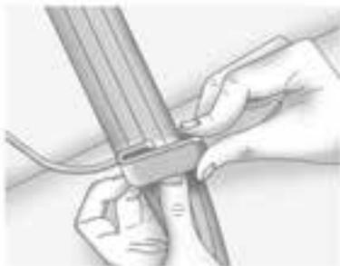
2. Posizionare la guida sulla cintura e inserire i due bordi della cintura nelle asole della guida.
