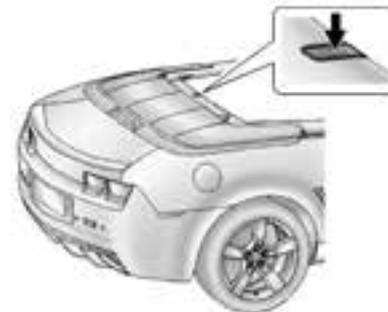
4. Rimuovere la copertura di rifinitura per accedere alla vite di scarico della pressione idraulica.
