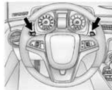
Il cambio scalare consente al conducente di controllare manualmente il cambio automatico. Per utilizzare il cambio scalare, la leva del cambio deve essere in M (modalità manuale). I veicoli dotati di questa funzione sono dotati di indicatori sul volante. I comandi si trovano sul retro dello sterzo. Spostare il comando di sinistra per scalare e il comando di destra per
