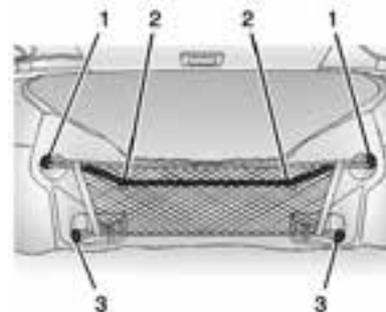
I ganci superiore (1) e inferiore (3) su ogni lato dell'apertura bagagliaio servono a fissare la rete.
